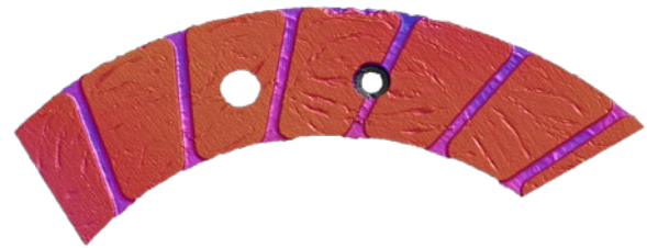
Detektion und Bewertung der Ausbrüche auf Kupplungsscheiben
