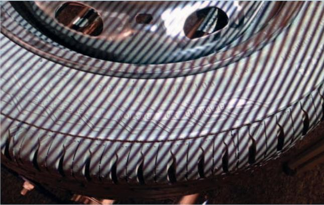
Das System projiziert sequentiell Muster auf die Seitenwand des Reifens und erfasst diese mit einer Kamera. Anschließend wird die so generierte 3D-Punktwolke mithilfe von Bildverarbeitungs-Algorithmen ausgewertet, um die gewünschten Merkmale zu berechnen.
