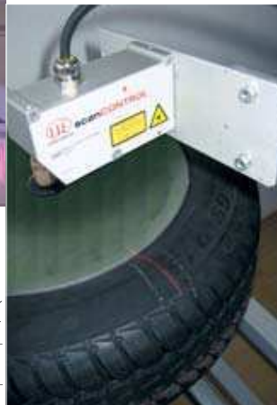
Die Laser-Linien-Scanner Scan Control werden für die Profil- und Konturmessung im laufenden Fertigungsprozess eingesetzt
