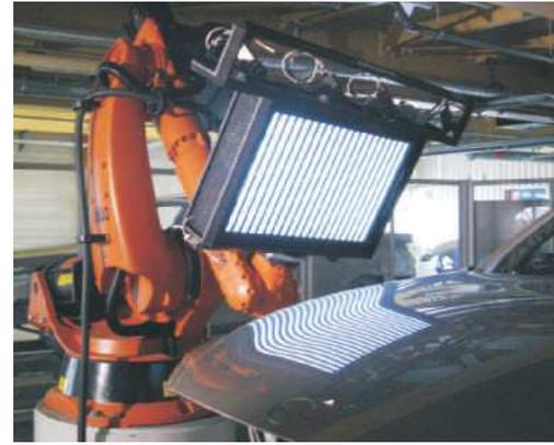
**O**ptische Messmethoden machen Fertigungsprozesse sicherer und zuverlässiger. Die optimierten Abläufe sparen Rohstoffe und Energie, verbessern die Qualität der Produkte und senken Herstellkosten. Sensorik- und Messtechnikspezialist Micro-Epsilon setzt verschiedene optische Messverfahren für Weg, Abstand, Position, Dimension und Oberfläche ein: Vom einfachen Punktlaser-Sensor bis zu komplexen 3D-Messsystemen.
