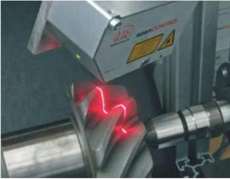
Zur objektiven Messung der Rundlaufeigenschaften von Getriebewellen mit Steckverzahnungen, Kegelräder mit Hypoidverzahnungen und ähnliche axiale Bauteile werden Profil-
